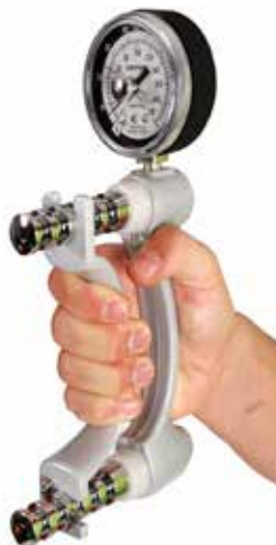
FIGURA 25 - EXEMPLO DE UM DINAMÔMETRO HIDRÁULICO DE MÃO
