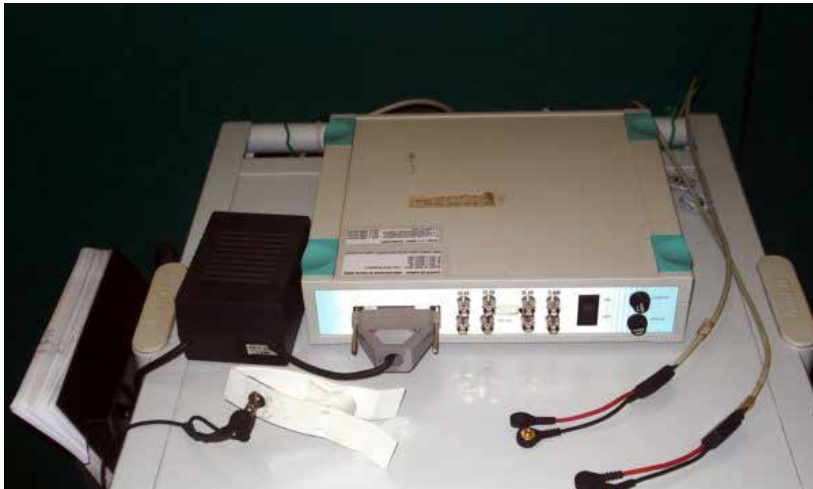
FIGURA 32 - EXEMPLO DO APARELHO DE ELETROMIOGRAFIA
