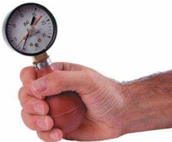
FIGURA 26 - EXEMPLO DE UM DINAMÔMETRO PNEUMÁTICO DE MÃO
